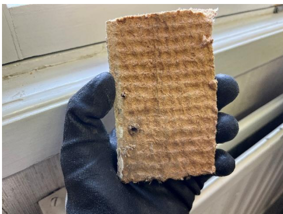
Kuva 34. Huokoisen puukuitulevyn takana on vähäistä värimuutosta.
