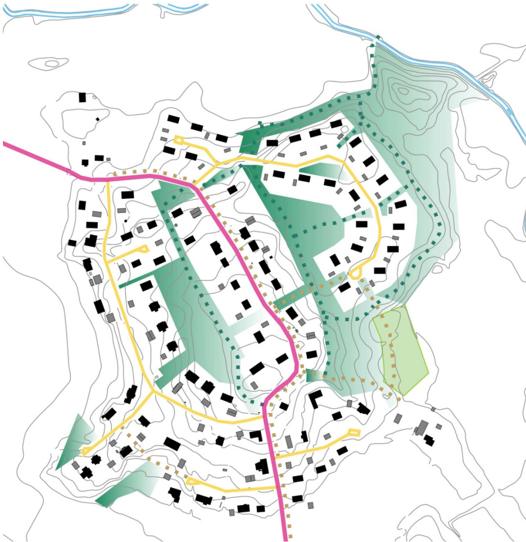
Kaavaehdotuksen liikenneverkko ja liittyminen nykyisen asuinalueen liikenneverkkoon: Punainen: kokoojkatu, keltainen: asuntokatu/ pihakatu, ruskea pisteviiva: kevyen liikenteen väylä, vihreä pisteviiva: ohjeellinen metsän polku. Virkistysalueet ja palstaviljelyalue ovat vihreinä alueina.
